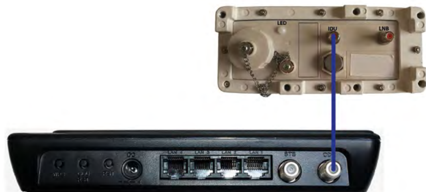
Prepojenie externej ODU a internej jednotky IDU.
