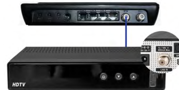
Prepojenie internej jednotky IDU a Set-top boxu.
