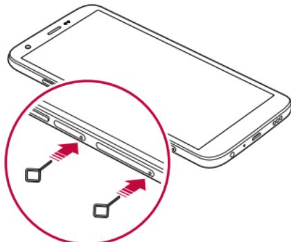
2 Tire de la bandeja de tarjetas usando el alfiler.
