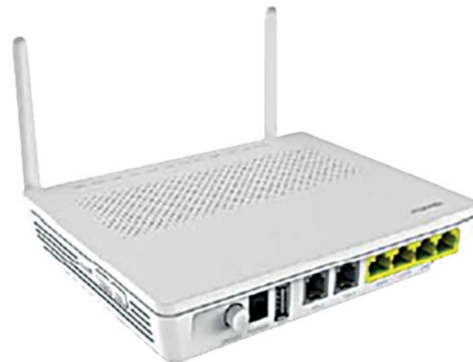
Obrázok 12 – konvertor Huawei EchoLife HG8245H.
