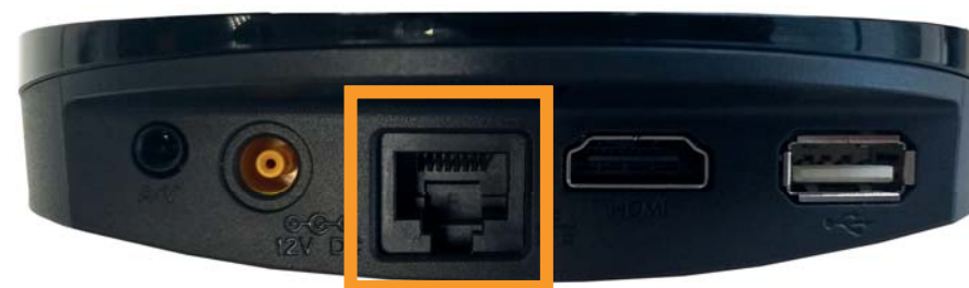
Obrázok 11 – Arris, vstup na pripojenie ethernetového kábla.
