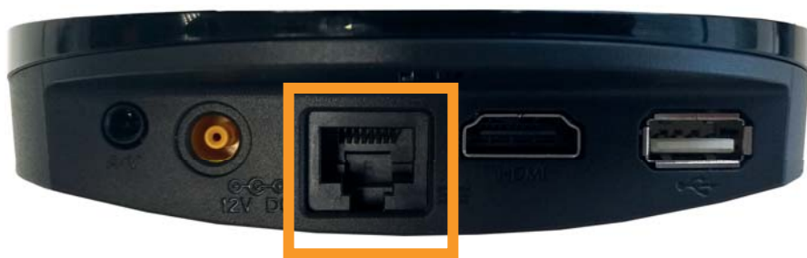
Obrázok 14 – Arris, vstup na pripojenie ethernetového kábla.
