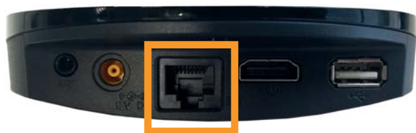
Obrázok 8 – Arris, vstup na pripojenie ethernetového kábla.
